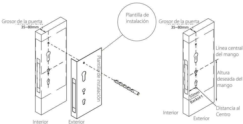
**Nota 1:** Alinear la plantilla de montaje a lo largo de la línea central vertical de la chapa (F) a la altura deseada del mango y fijela a la puerta.
