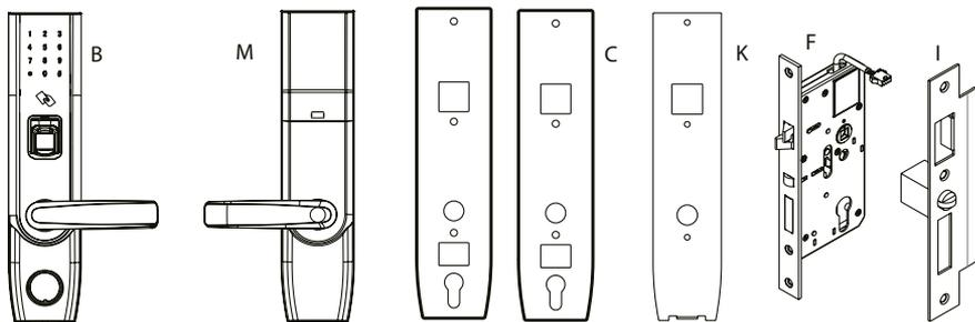
Contenido para montaje de puertas de 35 a 50 mm de espesor
