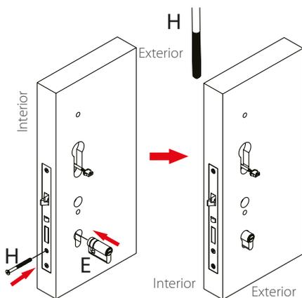
**Nota:** Instale el cilindro de la cerradura en la dirección correcta, luego apriete el tornillo (H) para fijarlo.
