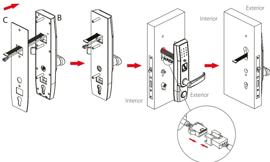
6. Instalar la placa de montaje (K) con la junta (C) en la puerta.
